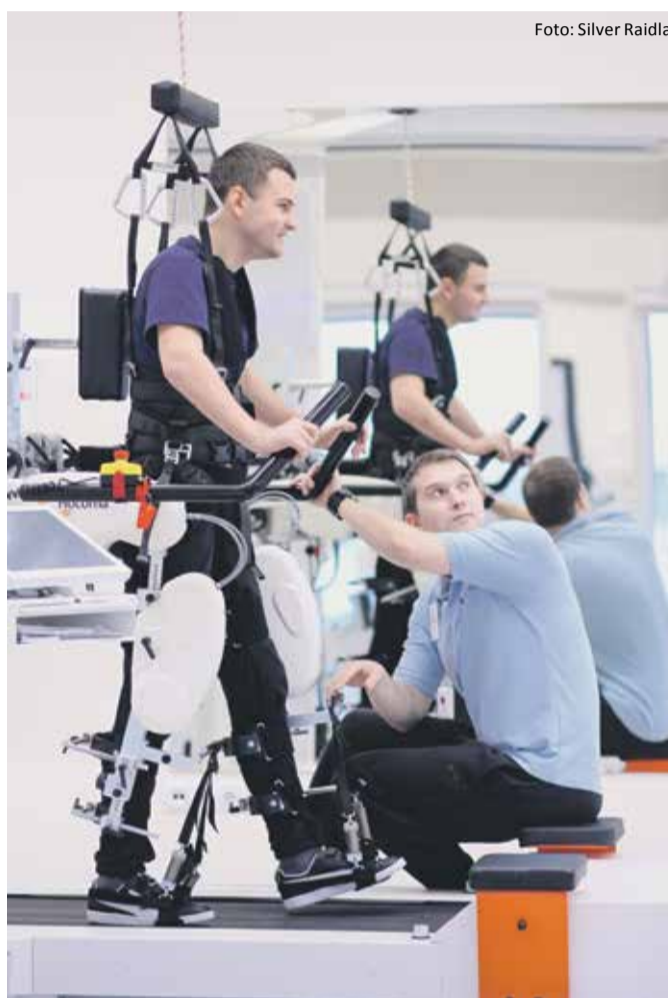
Kõnnifunktsiooni hindamine ja treening kõnnirobotil LokomatPro.
